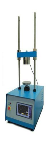
Prensa de carga universal Multivelocidades de 50 kN de capacidad con interfaz touch screen digital controlada por microprocesador para realizar todas las pruebas cuya velocidad y carga estén dentro de los límites de la prensa, por ejemplo, pruebas inconfinadas con gradiente de velocidad 0.65 mm/min, CBR 1.27 mm/min, Marshall 50.8 mm/min, tracción indirecta en asfalto, triaxial Rápida (UU), alimentación eléctrica, 110V, 60Hz, monofásica.
